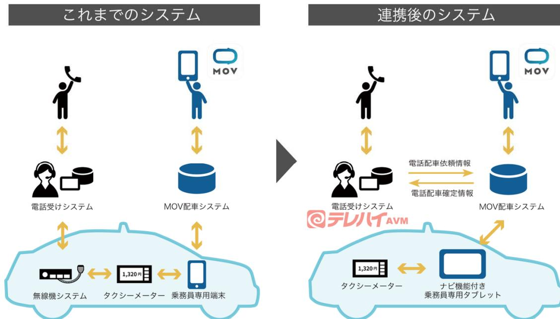
「MOV」は、お客様がアプリから配車依頼を行うと、タクシー車内に設置された乗務員専用端末に直接配車依頼がかかる「アプリ連携方式」を採用しており、タクシーが従来電話配車などで使用している無線機システムなどとは独立した配車システムです。そのため、タクシー事業者は無線機システムなどの入れ替えタイミングに影響を受けずに、「MOV」を導入することができました。また、「MOV」はタクシーメーターと連携し実空車情報をリアルタイムに反映できるため、タクシー事業者は従来の電話配車と重複することなく、追加の配車依頼を受けることができます。
