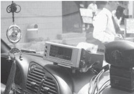
(上) GPS車載端末。液晶ディスプレイに配車指示が表示される
